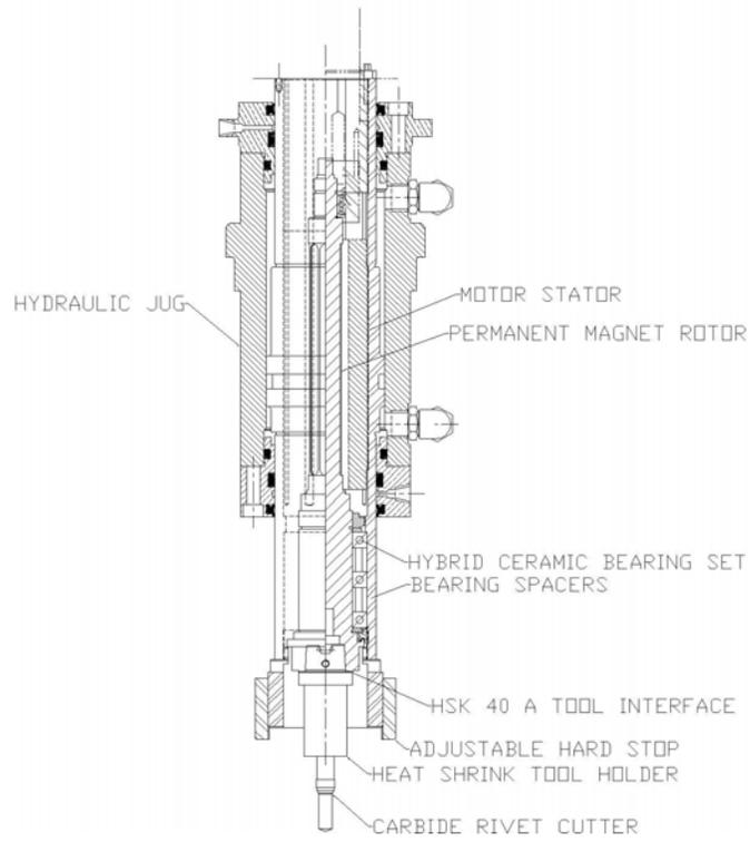
FIGURE 3: HIGH SPEED DRILL SPINDLE ASSEMBLY DRAWING
