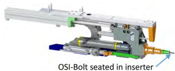
Figure 13. OSI-Bolt Inserter
