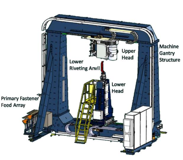
Figure 2. E7000 machine layout.
